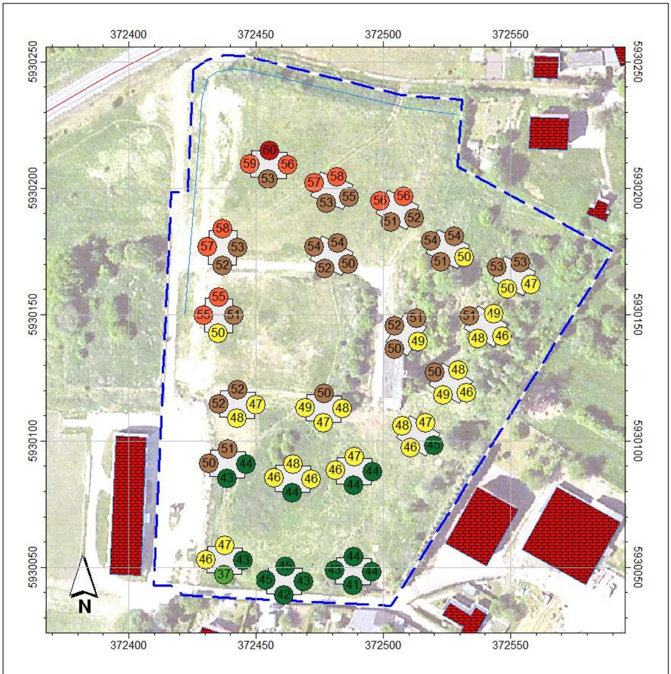
Abbildung 3: Beurteilungspegel Zeitraum TAG, ohne Lärmschutzwand bzw. -wall
